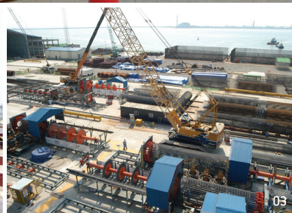
01 현장타설 말뚝 기초의 철근망 자동 조립 02, 04 케이싱 강관 제작 03 철근망 제작이 한창인 제작장 전경 05 케이싱 강관의 선단부 보강
